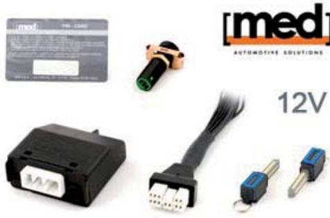
Impiego universale sui veicoli a 12 volt. Pin card con codice segreto per lo sblocco di emergenza. Dimensioni contenute. Cablaggio antimanomissione, con fili neri e connettore ad aggancio irreversibile. Possibilita' di cancellare le chiavi smarrite. Caratteristiche tecniche Interruzione diretta del motorino di avviamento sui veicoli a 12 volt. Tempo dell'inserimento automatico blocco-motore programmabile. Gestione di 8 chiavi elettroniche.
