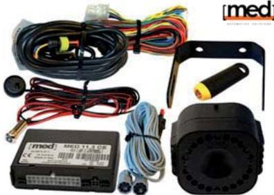
Ricevitore integrato per gestire tutti i dispositivi opzionali wireless LW MED. LED di segnalazione, uscita di stato fissa o temporizzata, uscita d'allarme supplementare, comando codificato MUX, pilotaggio diretto per chiusura centralizzata a comando negativo.
